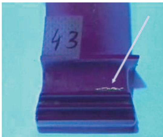
Rysunek 3.3. Wady zdiagnozowane a) techniką fluorescencyjną , b) techniką barwną [91]
